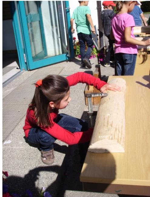
Mit Hilfe eines Zieheisens schälten wir die Rinde vom Halbstamm.
