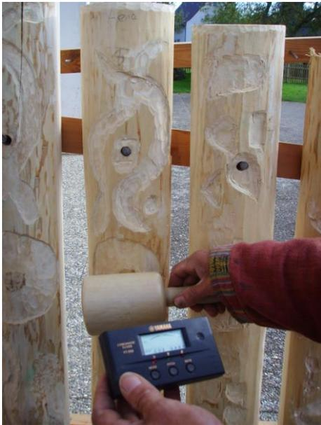
Mit einem Stimmgerät überprüfte Herr Lässig, wie die Halbstämme klingen. Durch das Herausarbeiten der Muster wurden die Stämme etwas tiefer oder höher und so musste die Motorsäge ran. Herr Lässig kürzte mit dieser die Stämme, sodass ein optimaler Klang vorlag.
